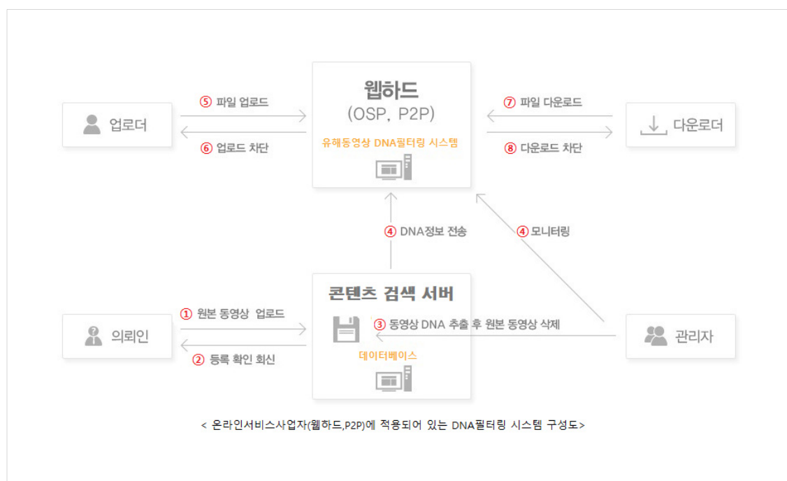
그림 1 ] 온라인 서비스 사업자 적용 DNA 필터링 시스템 구성도
